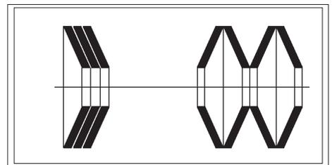
Pour des problèmes spécifiques, il s'avère nécessaire de nous consulter, mais à titre indicatif on peut affirmer qu'en accouplant plusieurs ressorts dans le même sens (en parallèle), on augmente le couple maximal de patinage réalisable; vive versa, en alternant le positionnement en série, au augmente la sensibilité de tarage.
