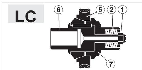
Consultando las figuras, la transmisión del movimiento se produce por fricción entre las superficies del eje (6) de la rueda helicoidal dentada (5) y del casquillo (7) que se someten a una determinada compresión (regulable) a través de la acción ejercida en las arandelas de muelles (2) por la tuerca de regulación o por la corona (1).
