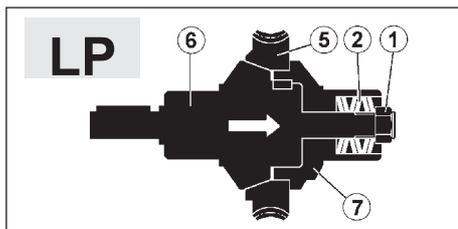
En se référant aux figures, la transmission du mouvement se fait par friction entre les surfaces de l'arbre (6) de la couronne dentée (5) et de la douille (7), qui sont soumises à une compression déterminée (réglable) à travers l'action exercée sur les ressorts Belleville (2) par l'écrou de réglage ou par la bague (1).
