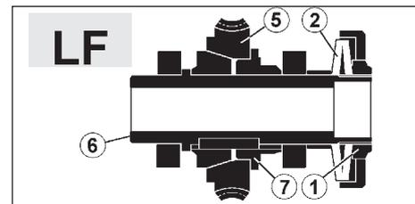
Consultando as figuras, a transmissão de movimento é feita pelo atrito entre as superfícies do eixo (6) da coroa dentada (5) e da bússola (7) que são submetidas a uma determinada compressão (regulável) por meio da ação exercida nas molas Belleville (2) pela porca de regulagem ou pela ponteira (1).
