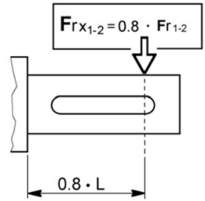
Les charges radiales indiquées dans les tableaux sont appliquées à mi-extension de l'arbre standard et elles se réfèrent aux réducteurs agissant avec facteur de service 1. Pour les charges qui n'agissent pas sur la ligne médiane de l'arbre côté sortie ou côté entrée, on a:
