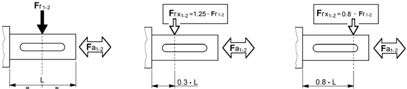
Les charges radiales indiquées dans les tableaux sont appliquées à mi-extension de l'arbre standard et elles se réfèrent aux réducteurs agissant avec facteur de service 1. Pour les charges qui n'agissent pas sur la ligne médiane de l'arbre côté sortie ou côté entrée, on a:
